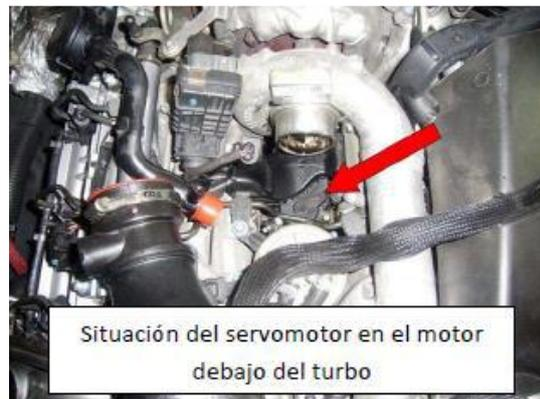
El que se dañe el sistema eléctrico del servomotor no tendría que provocar el fallo del turbo, pero los dos sistemas comparten el cableado en los polos positivo y masa y un fallo eléctrico en el servomotor hace que no pase corriente a la válvula electrónica del turbo y por lo tanto este no funcionará.
